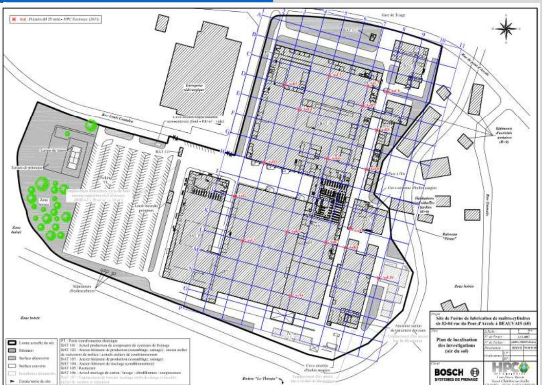
Figures n°19 : Cartographie des résultats d'analyses réalisées pour le paramètre « Métaux » (Echelle : 1/1 500 – fond de plan : HPC Environtec)
