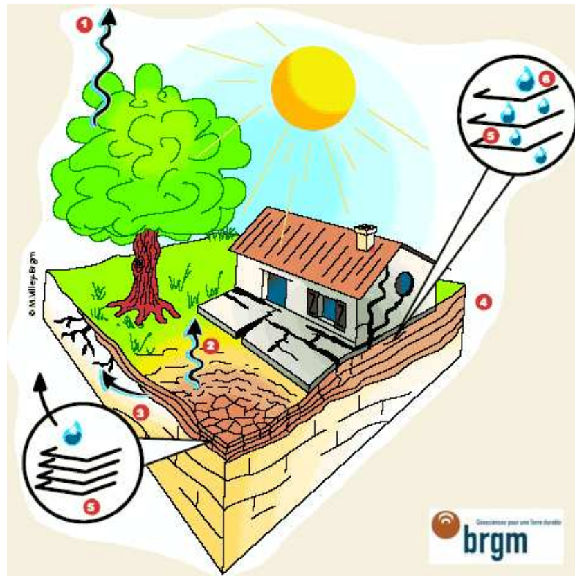
Schéma explicatif du phénomène retrait et gonflement des argiles (Source : http://www.argiles.fr/definitions.asp )
